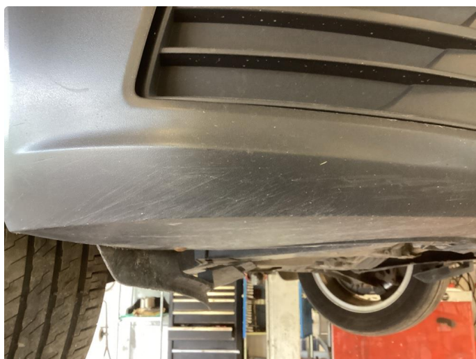
1.10 Ripe(r) ned til grunning
