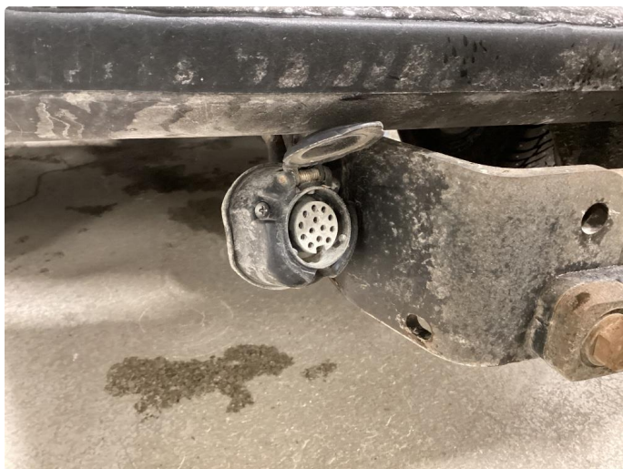
1.6 Tilhengerkontakt- innfesting skadet
