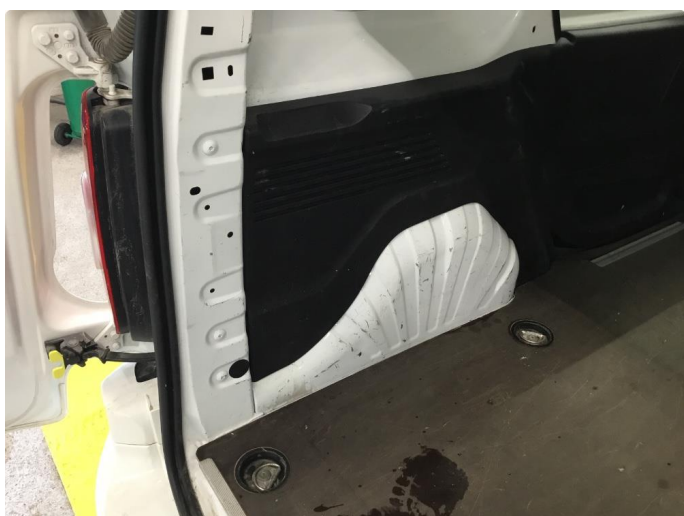
2.1 Bruksslitasje i varerom
