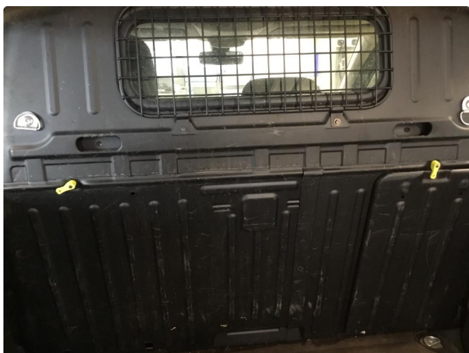
2.1 Bruksslitasje i varerom
