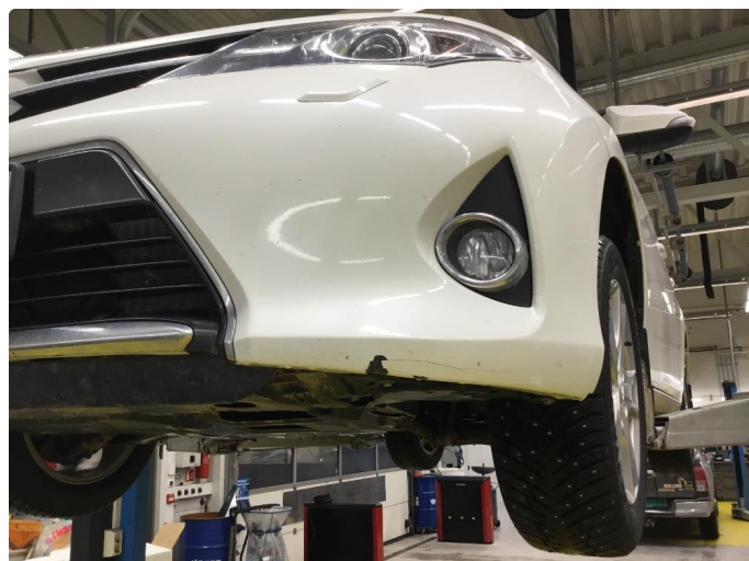
1.2 Sprekk i underkant av støtfanger foran.
