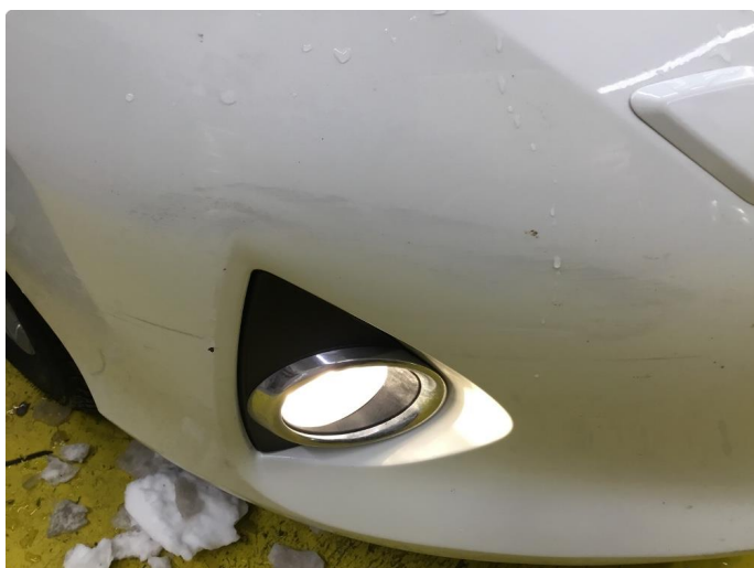
1.2 Sprekk i underkant av støtfanger foran.
