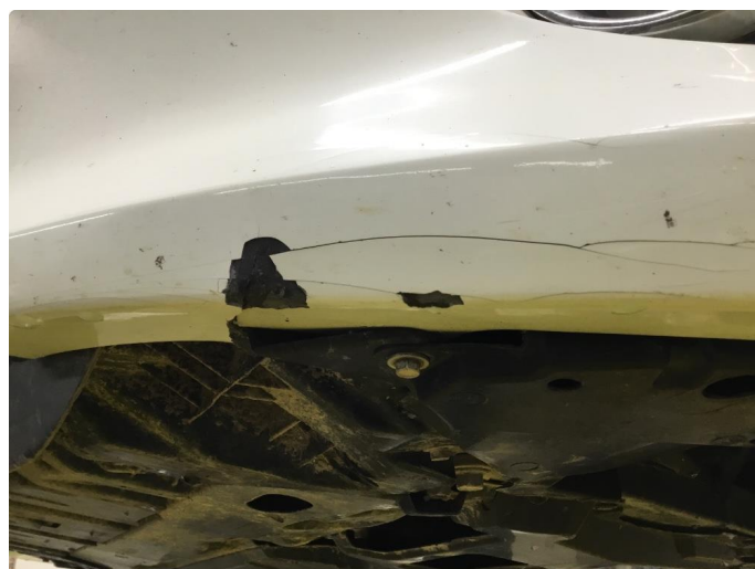
1.2 Sprekk i underkant av støtfanger foran.
