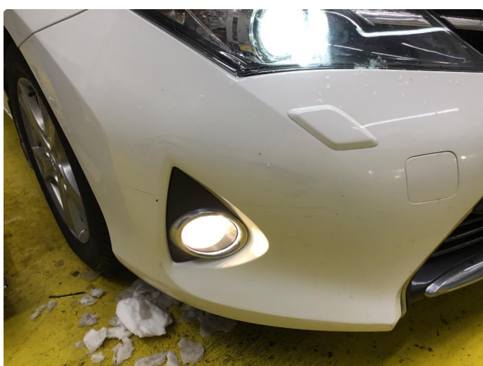
1.2 Sprekk i underkant av støtfanger foran.
