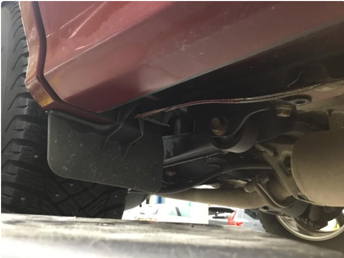
1.1 Liten skade på løftepunkt.
