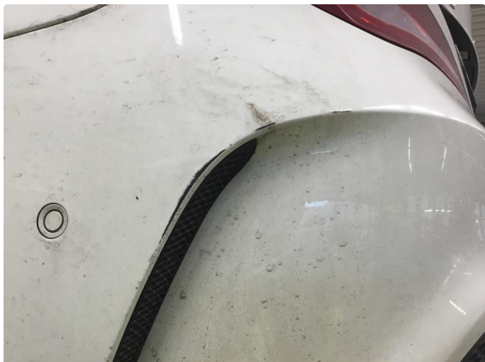
1.1 Ripe(r) ned til grunning
