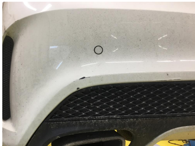
1.1 Ripe(r) ned til grunning
