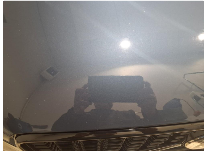
1.1 Noe stensprut på panser
