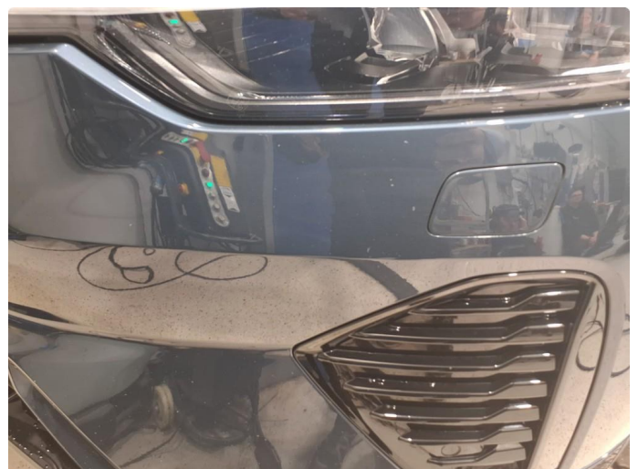
1.5 Noe steinsprut på frontfanger
