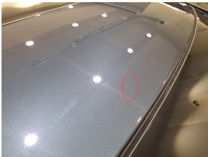
1.6 Noe steinsprut på tak
