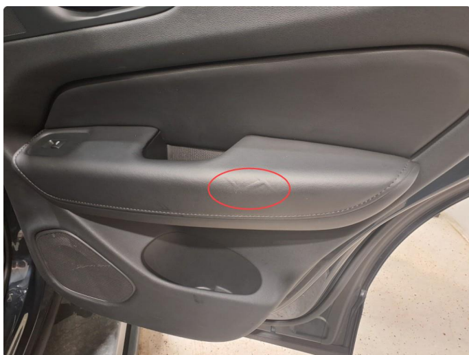
2.1 Merke i dørtrekk høyre bak
