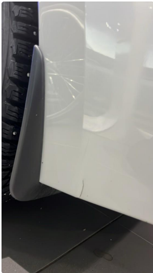
1.1 Liten sprekk støtfanger v.bak
