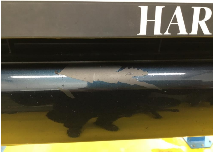
1.1 Lakk flasset av
