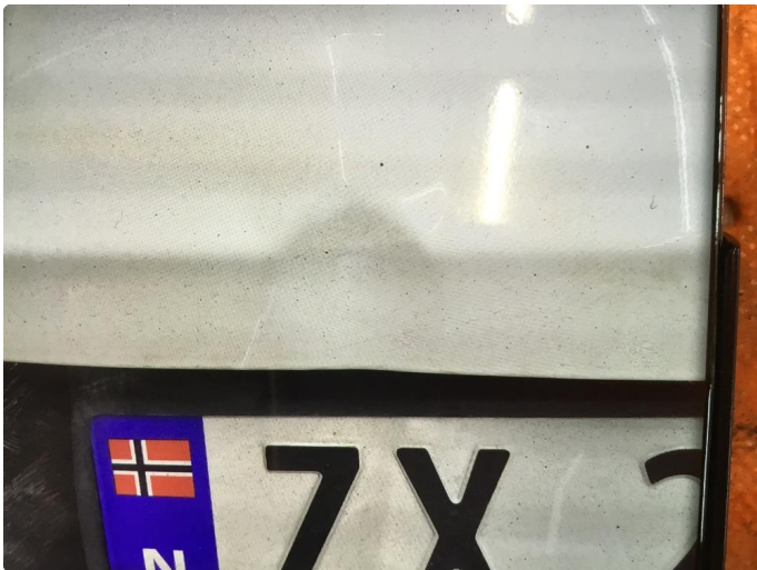
1.1 Bulk, blir rettet opp.
