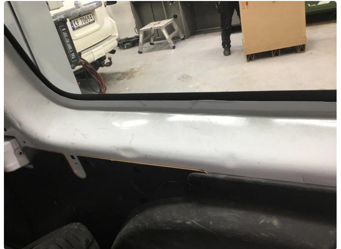
1.2 Ripe(r) ned til grunning
