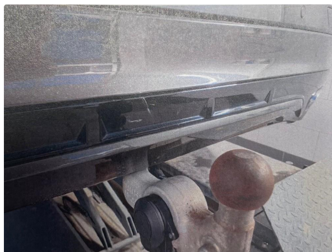
1.4 Noen riper i støtfanger
