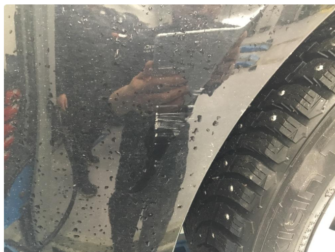
1.3 Riper på støtfanger bak
