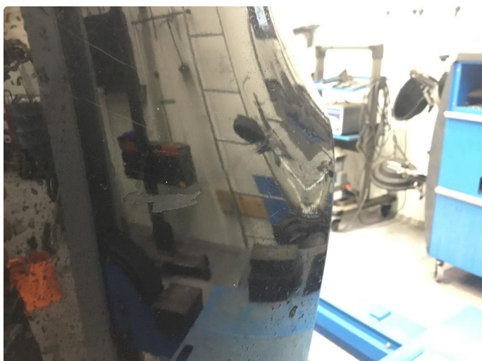
1.3 Riper på støtfanger bak
