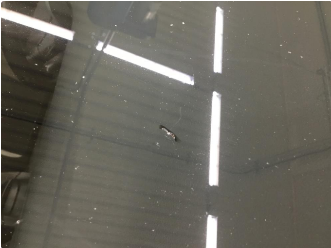
1.2 Steinsprut med sprekk utenfor synsfelt
