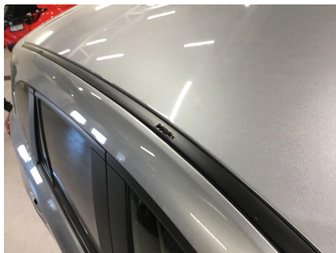
1.7 Deksler på tak/rails mangler
