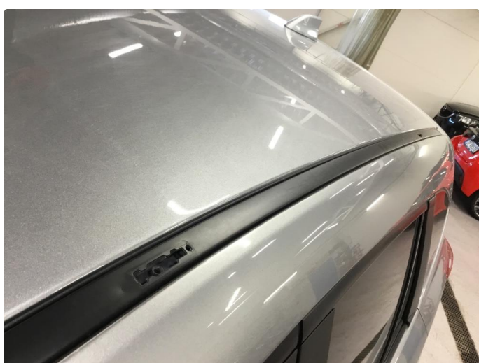
1.7 Deksler på tak/rails mangler
