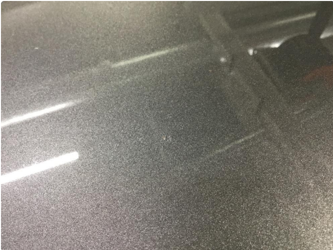
1.3 Ripe(r) ned til grunning
