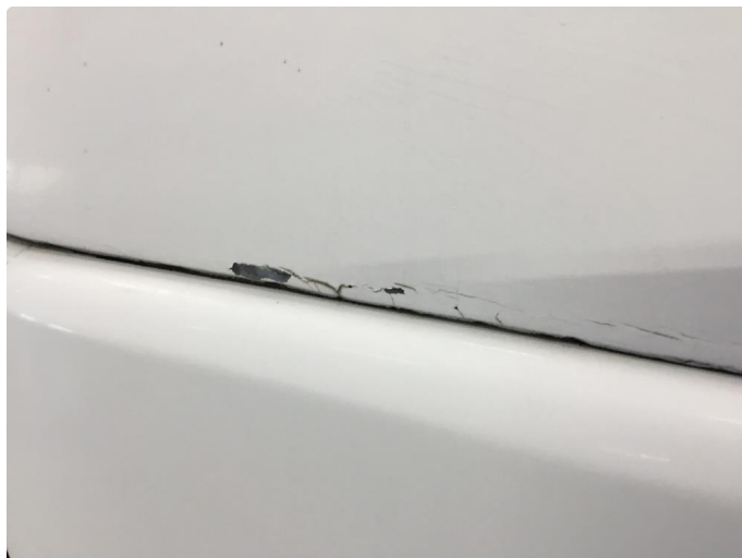
1.5 Lakksår, krakeleringer og småskader nedkant overbygg lastekasse, begge sider.
