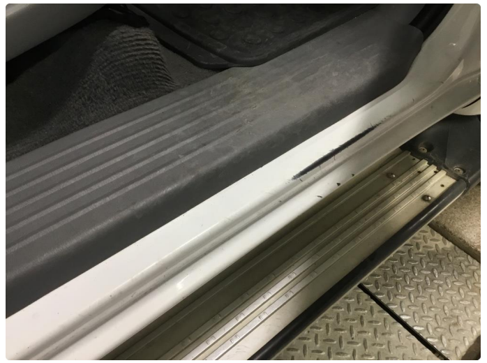
1.6 Slitt lakk dørterskel begge, men mest venstre.
