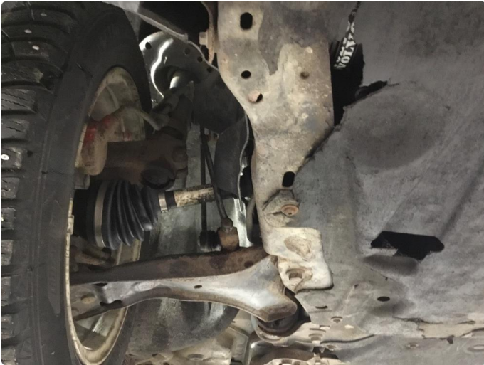
1.2 Overflate rust under bil. Ikke noe farlig rust
