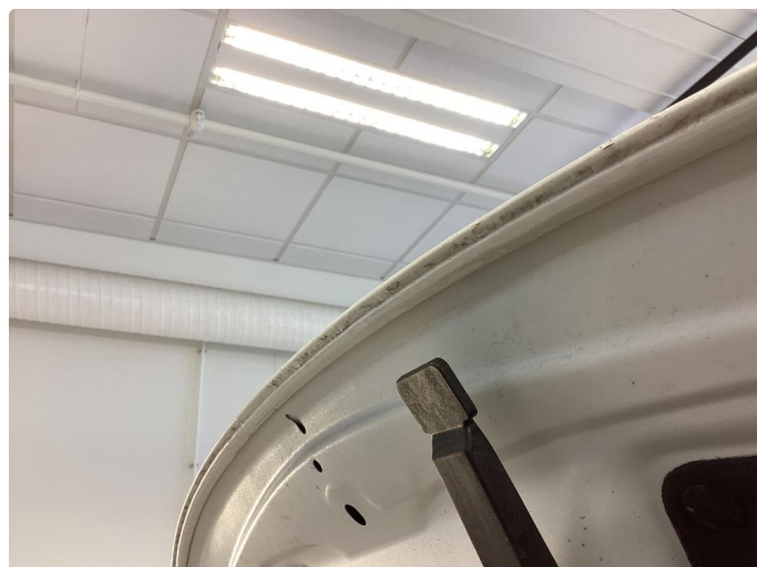
1.1 Rust i fals
