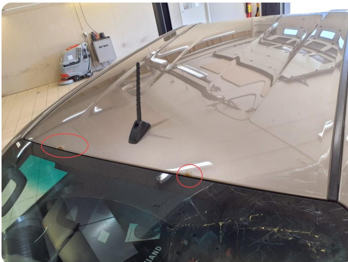
3.4 Rust Front rute må demonteres.
