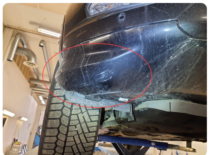
2.6 Skrubbskader underkant /noen riper og en del steinsprut
