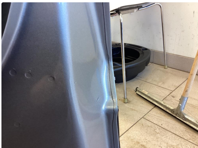
1.1 Rust i fals
