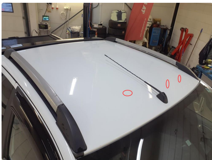
2.9 Steinsprut med rust
