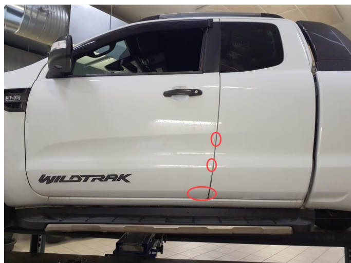
2.3 Ripe ned til grunning
