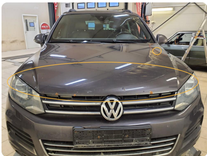
2.3 Korrosjon/sinkslipp Og en liten bulk
