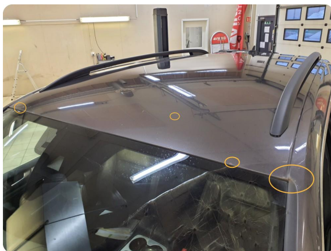
2.15 Steinsprut med rust
