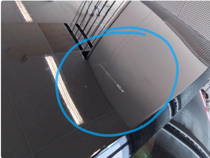
1.1 Ripe(r) ned til grunning
