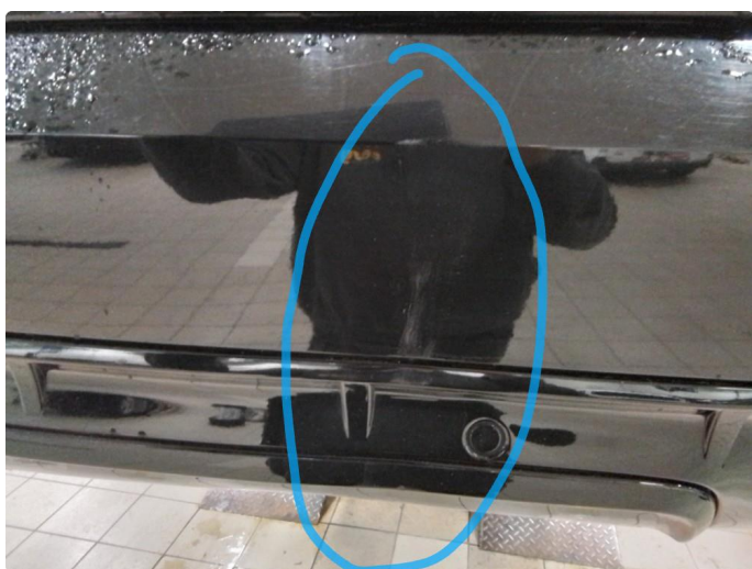
1.4 Bulk med lakkskade, smartrep
