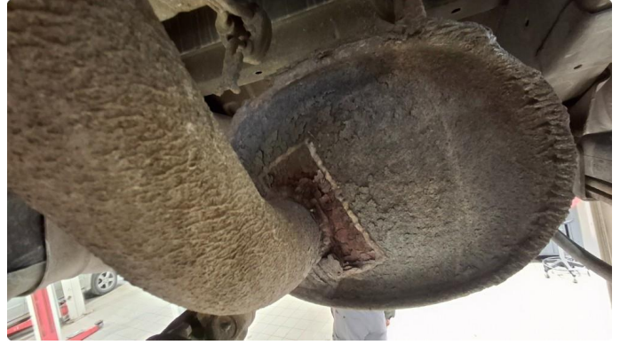
5.1 Defekt eksosanlegg fra dpf og bakover.
