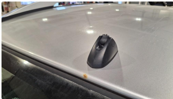
3.8 Noe steinsprut på tak.
