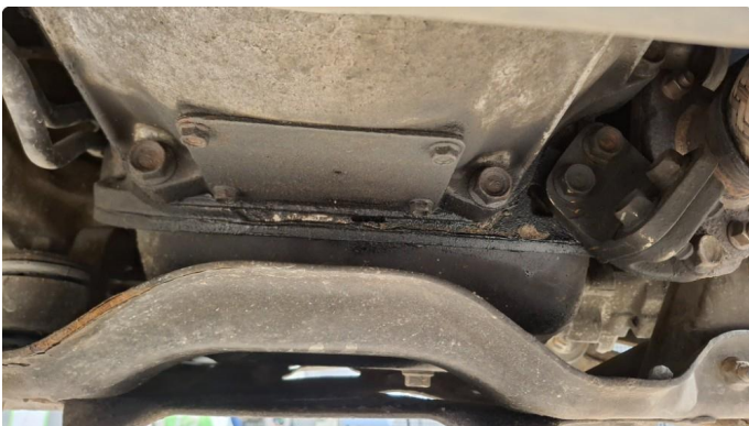
5.3 Oljelekkasje fra motor
