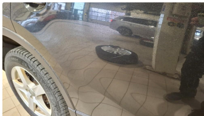
2.4 Ripe ned til grunning.
