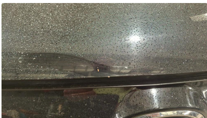
2.1 Noe steinsprut med rust.
