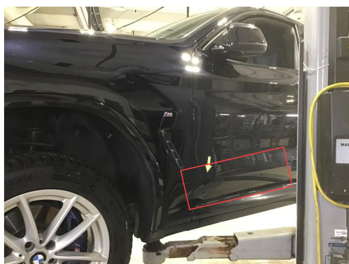
1.2 Noe slitasje nedre del dører, poleres.
