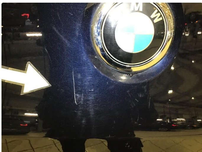
1.3 Noen bruksmerker på bakluke, poleres.
