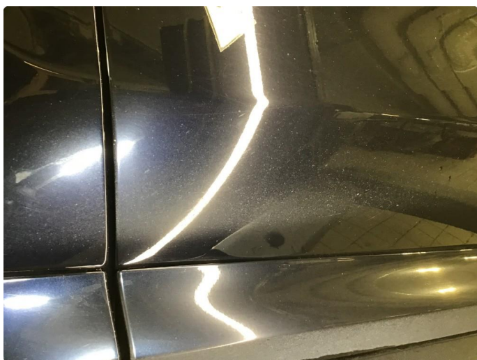
1.2 Noe slitasje nedre del dører, poleres.
