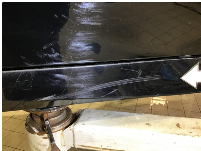
1.6 Noe bruksmerker på kanaler, poleres.
