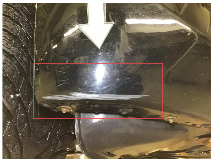
1.5 Noen skrubbermerker underkant fremfanger, regnes som normal bruksslitasje.
