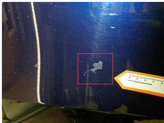
1.1 Noe riper / sår v-framdør, er flekket tidligere. ( Normal bruksslitasje )
