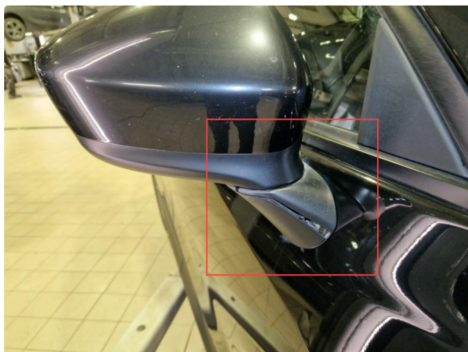
1.5 Defekt speilinnfelling + skadet speihus / fot h-side.
