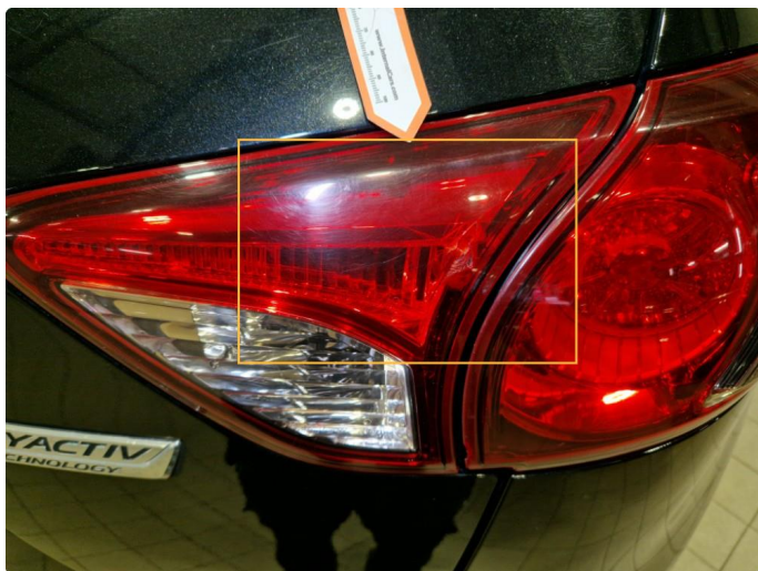
2.2 Sprekkdannelser indre + ytre baklykt h-side.
