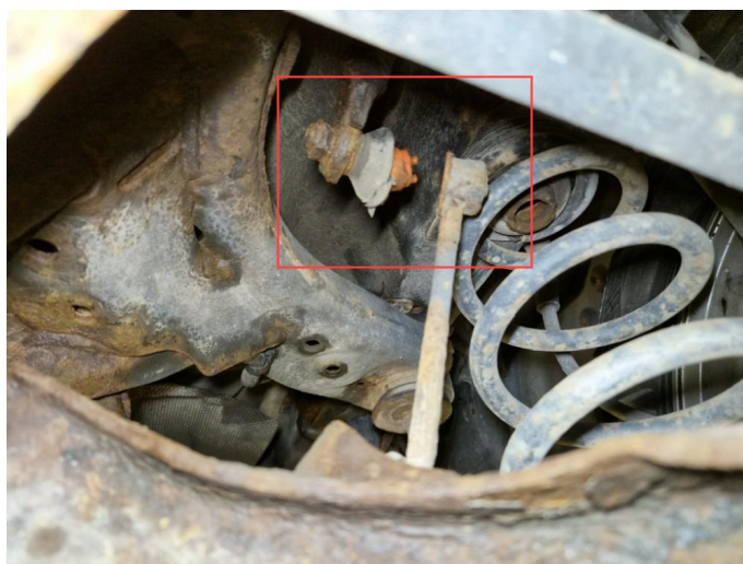
4.4 Utslitt / avgått lenkearm v-bak, defekt mansjett lenkearm h side bak.
