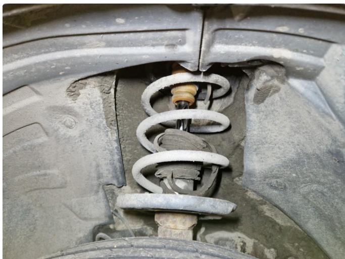
4.1 Sprukket støtdempermansjett h+v side fram.
