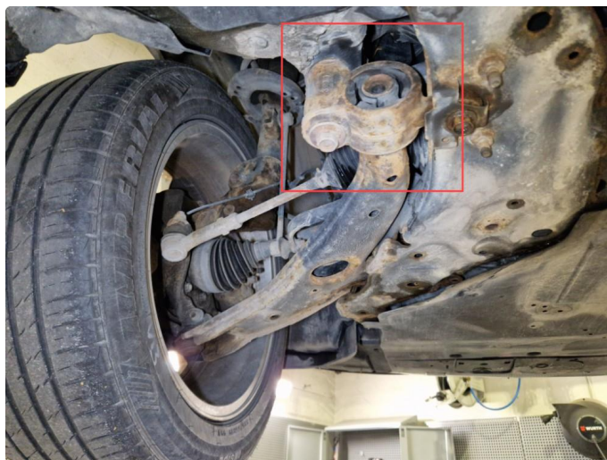
4.6 Slitt bakre bærearmsforing v-side fram.
