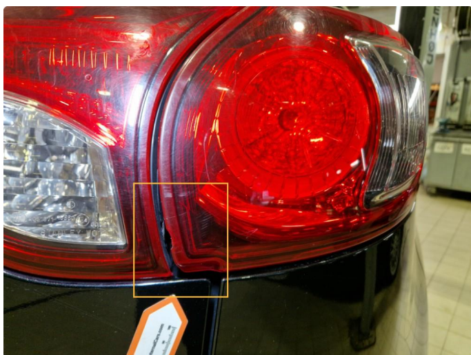
2.2 Sprekkdannelser indre + ytre baklykt h-side.
