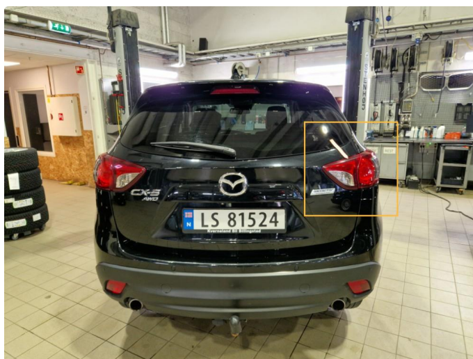
2.2 Sprekkdannelser indre + ytre baklykt h-side.
