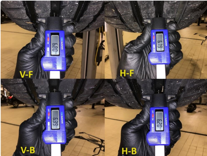
1.1 Mønsterdybde sommerdekk målt ved takst 18.07.2024, 57.567km.
