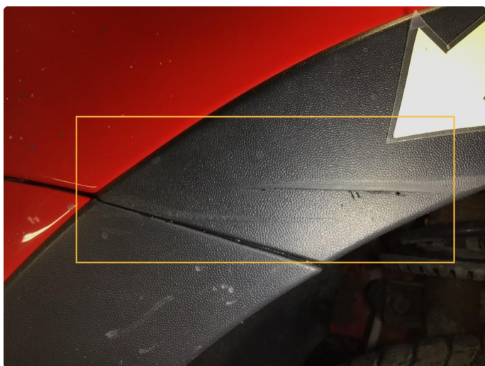
1.7 Skadet skjermutbygger v-fram.
