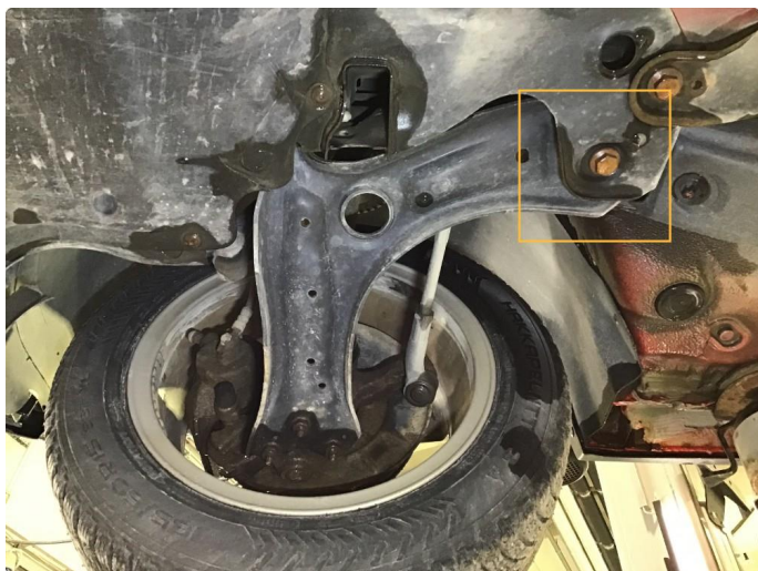
4.2 Slitt bakre bæreamsforing h+v side fram.
