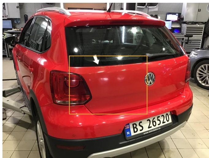
1.5 Rust øvre del bakluke + opplakkert noe dårlig.
