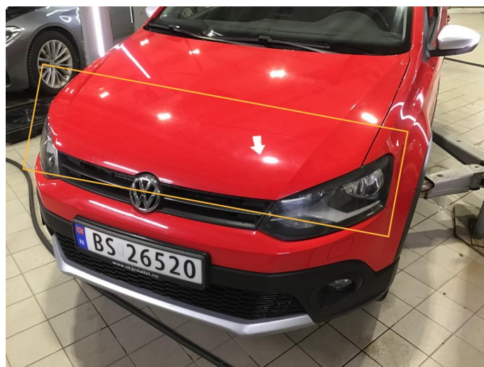
1.2 Mye steinsprut panser.
