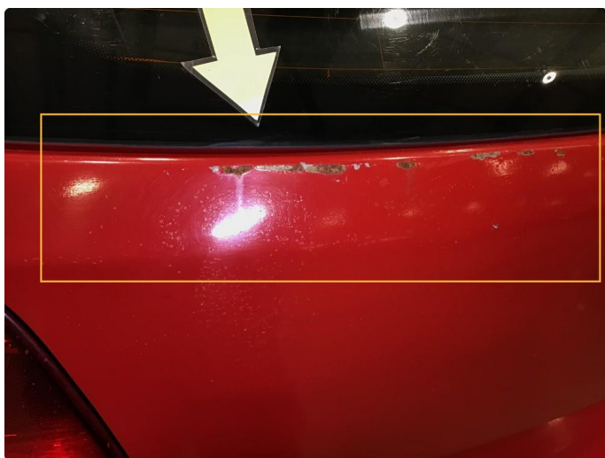
1.5 Rust øvre del bakluke + opplakkert noe dårlig.
