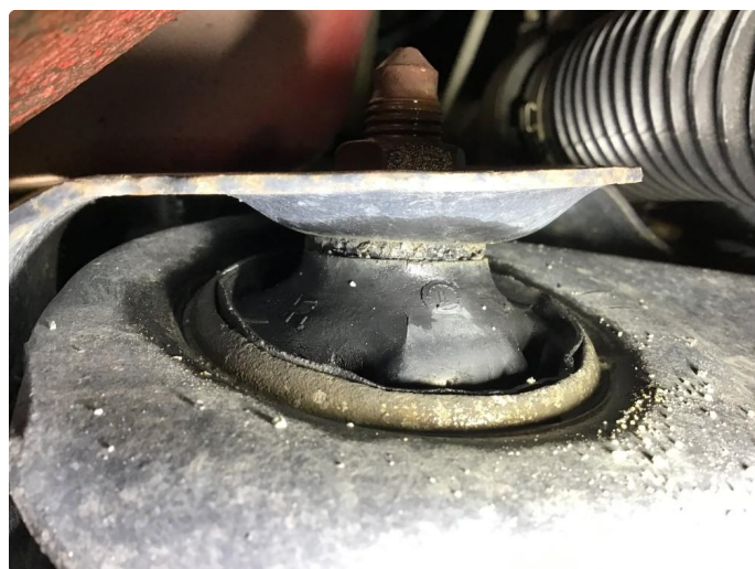
4.2 Slitt bakre bæreamsforing h+v side fram.
