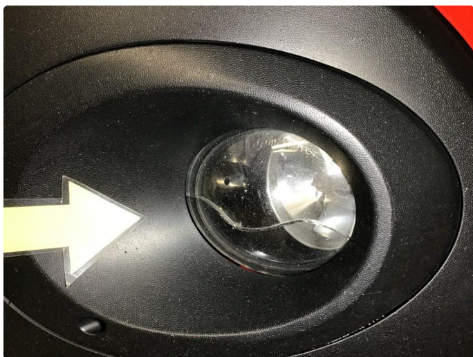
2.1 Sprukket lykteglass tåkelykt v-side fram.
