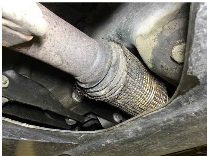
3.1 Løs innfesting flexikobling , ingen lekkasje pr. nå.
