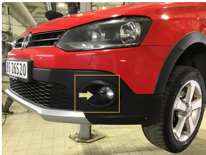
2.1 Sprukket lykteglass tåkelykt v-side fram.
