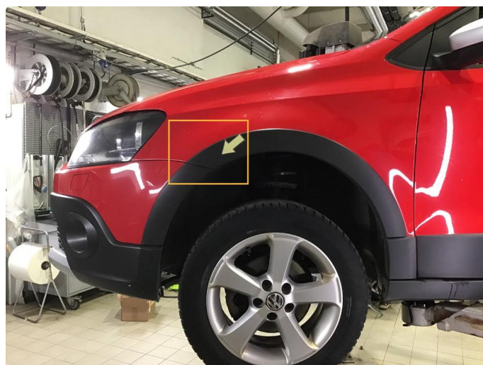
1.7 Skadet skjermutbygger v-fram.
