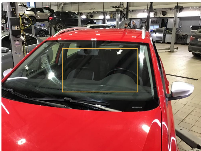
1.13 Mye små steinsprut frontrute , for små til og repareres.
