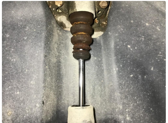
4.1 Utslitte støtputer til støtdemper h+v side bak.
