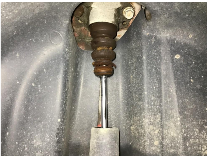
4.1 Utslitte støtputer til støtdemper h+v side bak.
