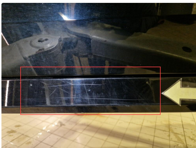
1.3 Noe riper kanalskjørt v-side .
