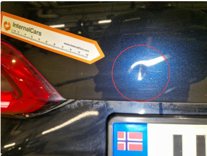
1.2 1 Stk bulk øvre del v-side bakluke + 1 stk liten p-bulk nedre del. Noe riper ved baklukeemblem.
