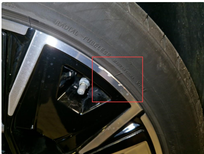
1.2 Sår / små skader sommerfelg h-fram + h-bak .
