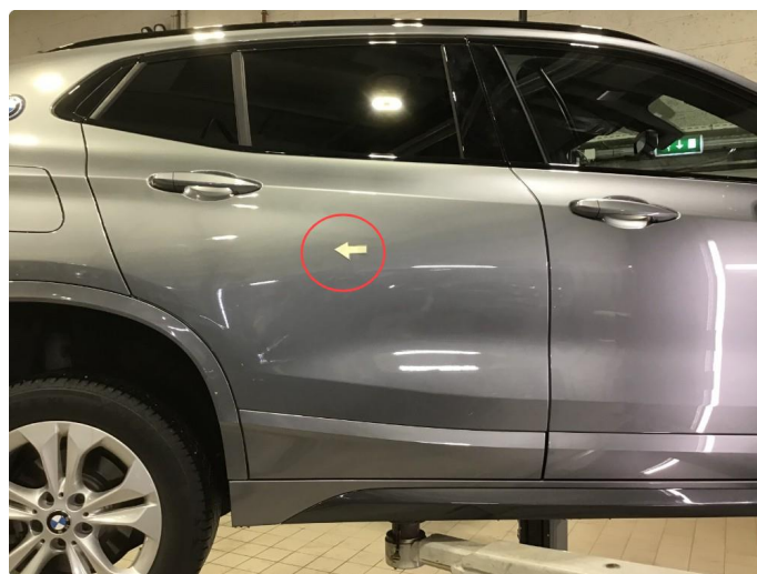
2.2 Liten p-bulk h-bakdør, regnes som normal bruksslitasje.
