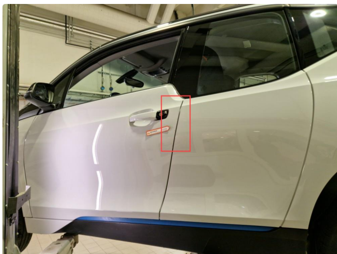
1.2 Flere lakksår bakre del v-framdør.
