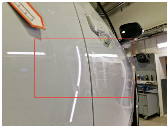
1.1 Noe riper/ merker langsgående h-ram og bakdør.
