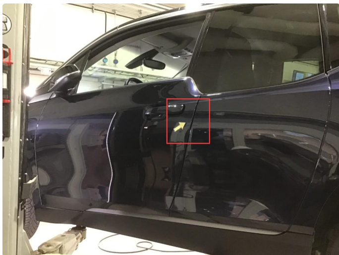
1.2 Liten p- bulk + lakksår bakre del v-framdør, poleres og flekkes.
