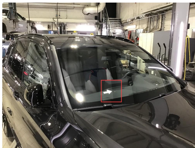
1.6 Steinsprut på frontrute, repareres.
