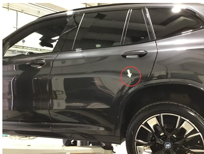
1.2 Liten p-bulk bakre del v-bakdør, regnes som normal bruksslitasje.
