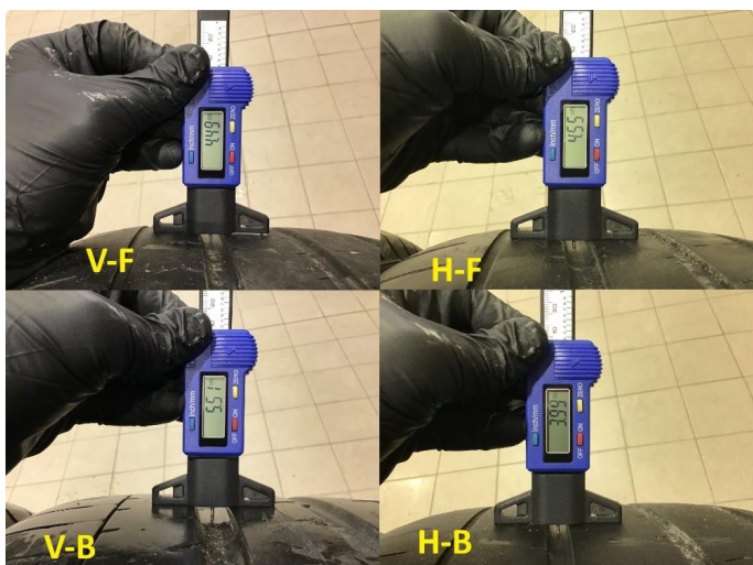
1.4 Mønsterdybde sommerdekk målt ved takst 23.12.2024, 45.128km.
