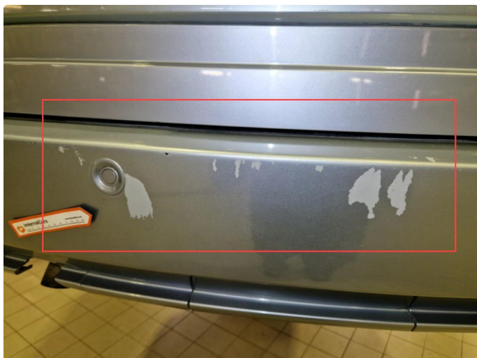
2.13 Bruksmerker / slitasje bakfanger.
