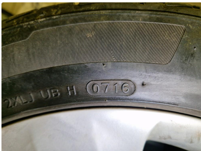
2.6 Sommerdekk produsert 07/2016 Hankook ventus S1 Evo 2 SUV 235/50R 18 97V.
