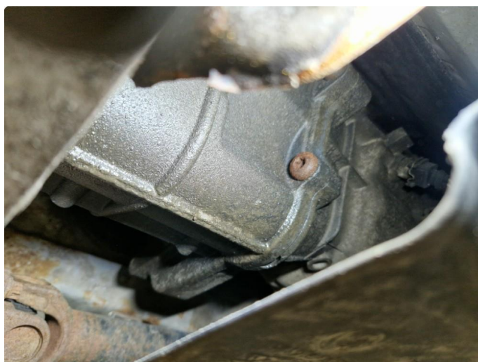
7.1 Lekkasje VTG / fordelingsgirkasse.
