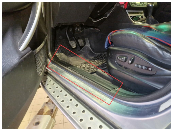
2.11 Skadet dørkarmlist v-fram.
