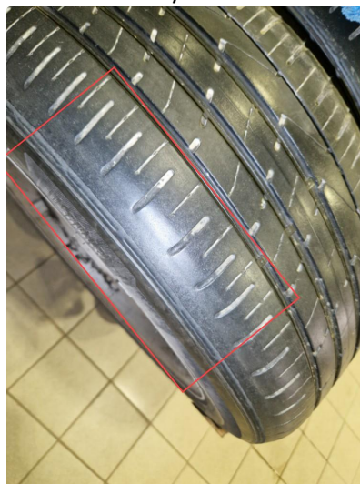
2.7 Skjeivslitasje innside sommerdekk.
