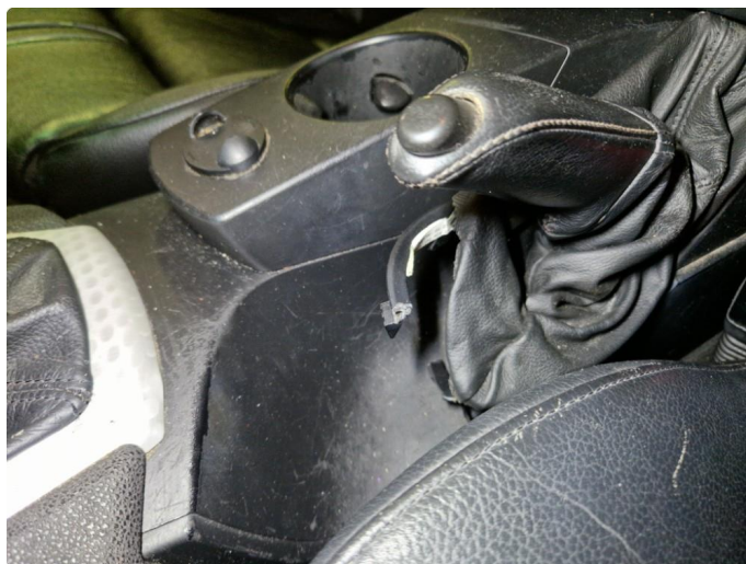
8.1 Slitasje skinnbelg til parkbrems.
