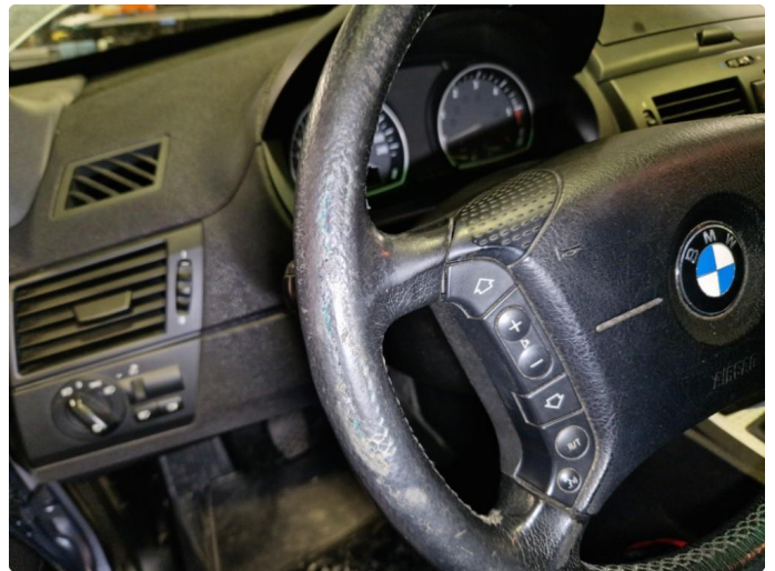
8.4 Slitasje skinnTREKK ratt.
