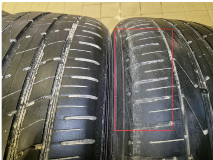
2.7 Skjeivslitasje innside sommerdekk.
