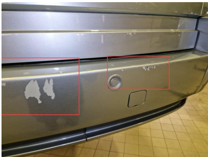
2.13 Bruksmerker / slitasje bakfanger.
