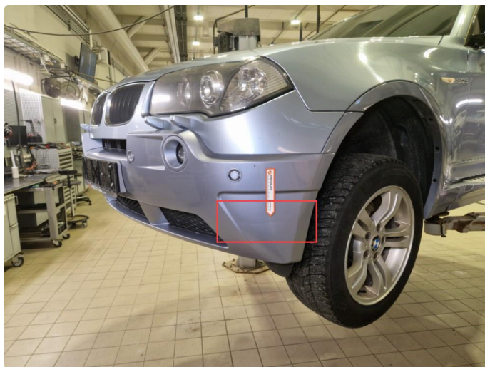
2.12 Bruksmerker / slitasje frontfanger.
