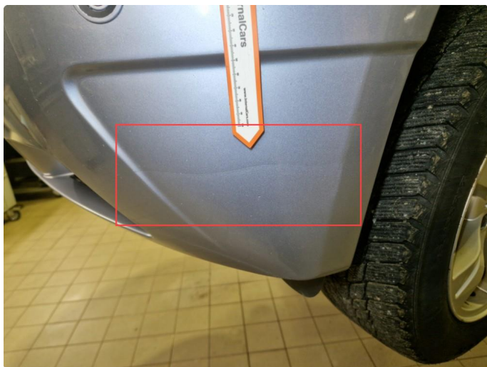
2.12 Bruksmerker / slitasje frontfanger.
