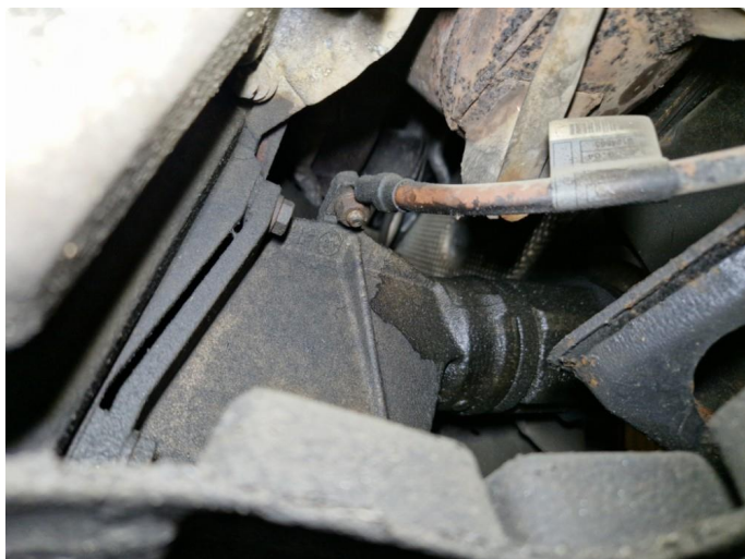
4.1 Oljelekkasje fra motor.
