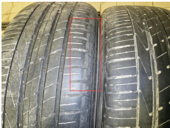
2.7 Skjeivslitasje innside sommerdekk.
