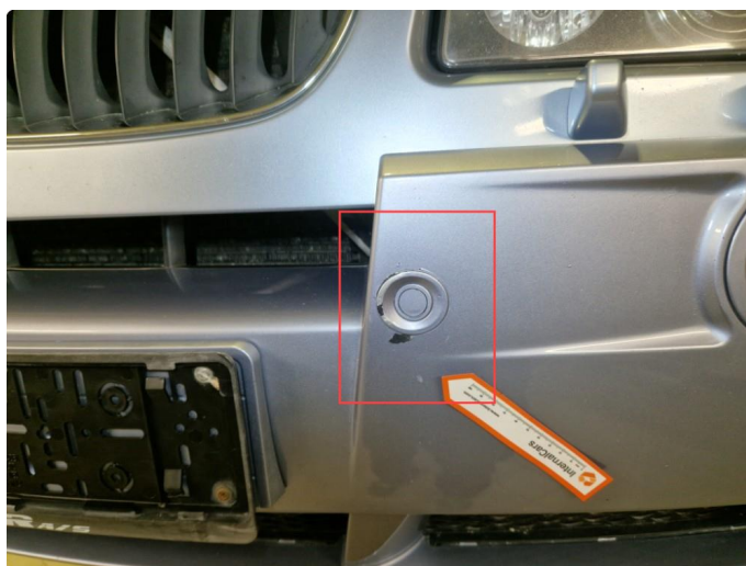
2.12 Bruksmerker / slitasje frontfanger.
