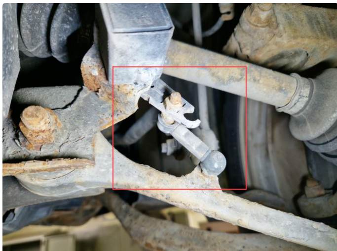
1.1 Skadet stag til nivåsensor h-fram.
