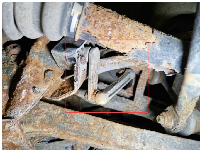
1.2 Stag til nivåsensor h-bak sitter fast.
