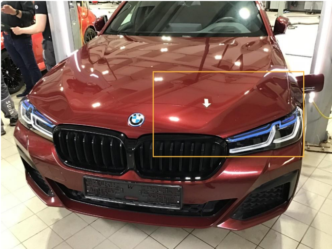
1.1 Noen steinsprut panser , normal bruksslitasje.
