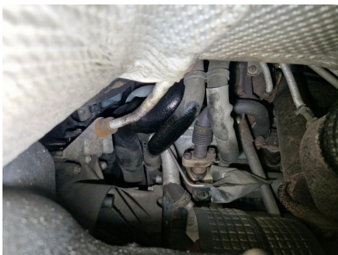
3.4 Oljelekkasje fra turbo.
