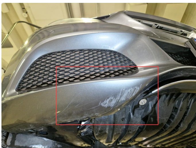
1.4 Noen skrubbermerker underkant fremfanger, regnes som normal bruksslitasje.
