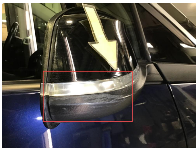
1.2 Noe bruksmerker på speilhus h-side, poleres.
