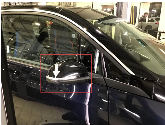
1.2 Noe bruksmerker på speilhus h-side, poleres.
