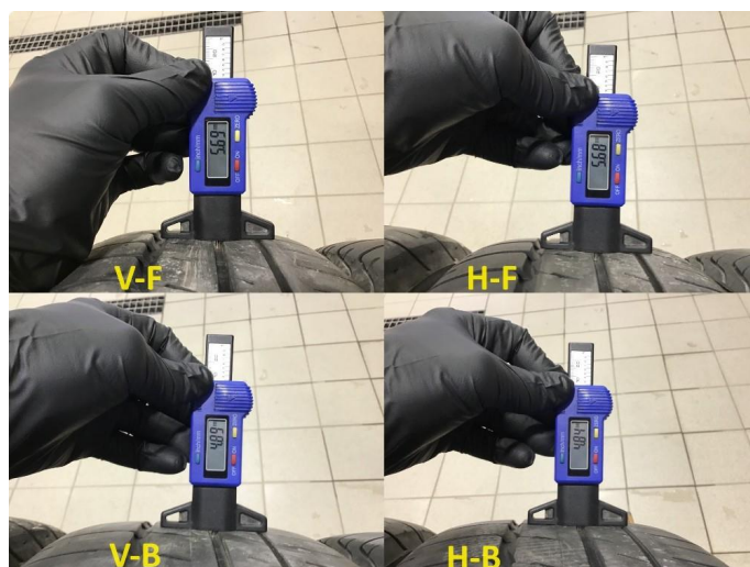
1.2 Mønsterdybde sommerdekk målt ved takst 04.04.24, 45.051km.
