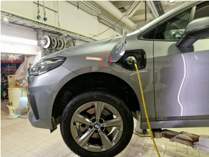
1.1 1 Stk liten p-bulk v-framskjerm ( Normal bruksslitasje ).
