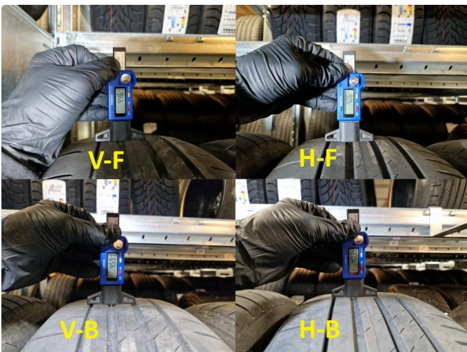
1.3 Dekkdybdemåling sommerdekk utført 27.11.2025 på km : 27.546.
