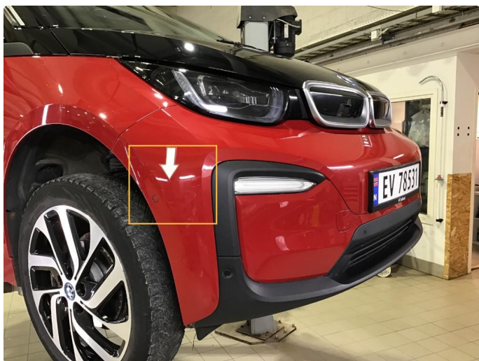
1.7 Noe lakkslitasje på frontfanger høyre side.
