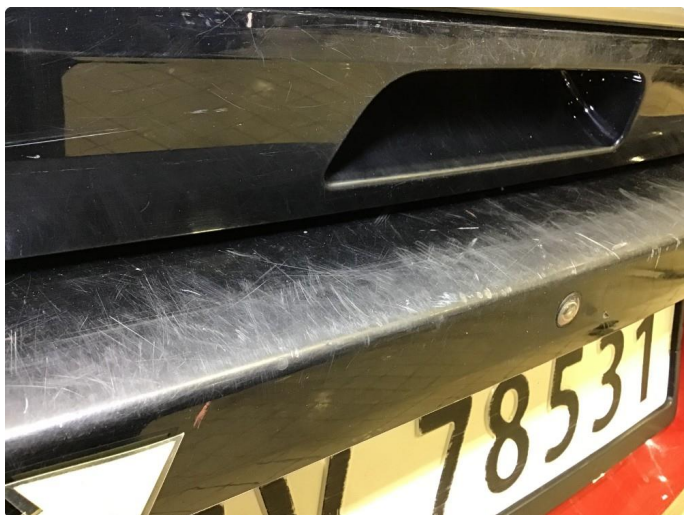
1.6 En del slitasje på innlastingssone bakfanger, poleres.
